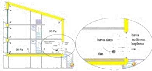
Şekil 1.4 Pasif ev kesitinde Blower Door Testi prensibinin gösterimi
