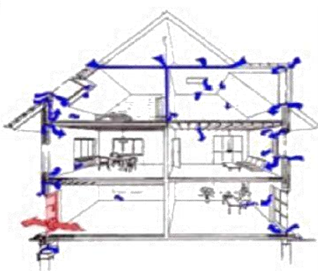
Şekil 1.5 Hava basıncı testinin şematik gösterimi
